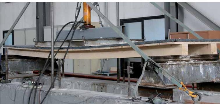
Solaio JPCT prima della rottura
