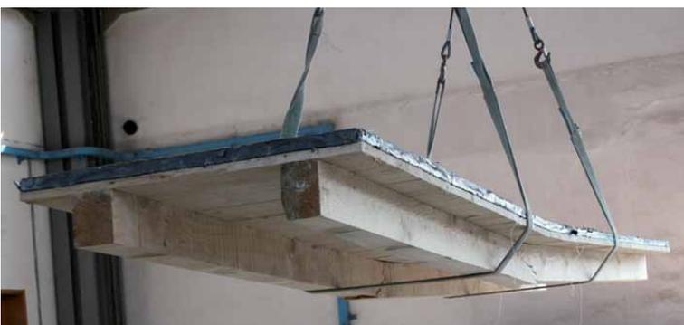
Anche dopo la rottura delle travi il Traliccio LPR® mantiene completamente aderente la soletta alle tavole
