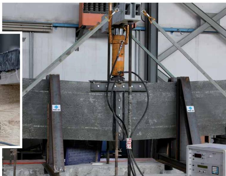
Solaio JPCT prova a taglio orizzontale
