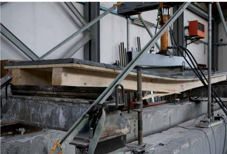
La rottura del solaio JPCT
